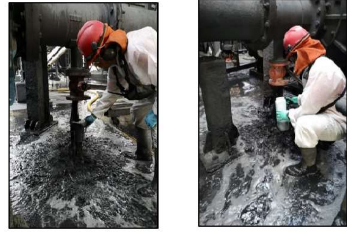
Figura 39. Toma de muestra despiches de bombas. (A) Descarga concentrado de la celda y (B) Descarga acondicionador 1.
