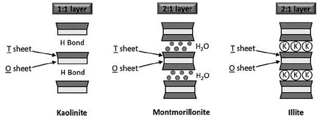
Ilustración de algunas estructuras de arcillas
