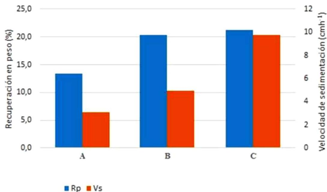
Flotación de relaves con distintas dosis de floculante Kemira a una dosis de colector de 25 g/t de AERO 845<sup>®</sup> contrastado con presencia de coagulante (A) sin floculante ni coagulante (B) sólo floculante (20 g/t) y (C) floculante (30 g/t) + coagulante (8 g/t)
