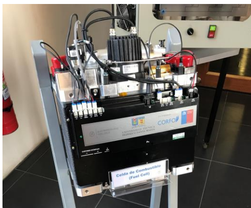
Celda de Combustible de 15 kW
