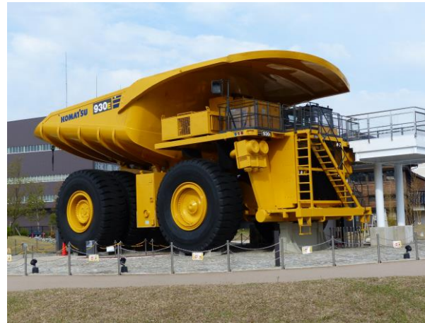
Komatsu 930E-4 - 290 Ton. Carga Útil Diesel 16 Cil. – 1902 kW – 2550 HP Drive Train Eléctrico (Propulsión)
