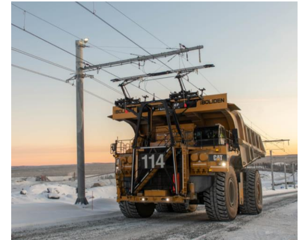
CAEX Caterpillar con 'Trolley Assist'
