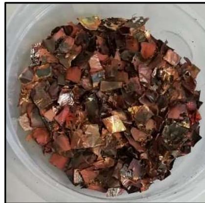
Fracción metálica rica en cobre
