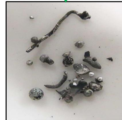
Fracción metálica rica en estaño y plomo
